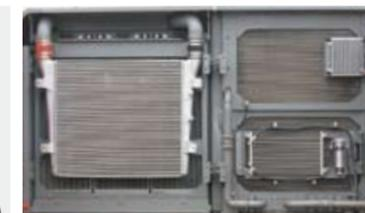
ラジエータ、オイルクーラを別置きに変更。オイルクーラを別置きにすることでオイルの冷却効率をアップし、さらに脱着性も改善。これにより、清掃の手間と時間を大幅に簡素化します。
