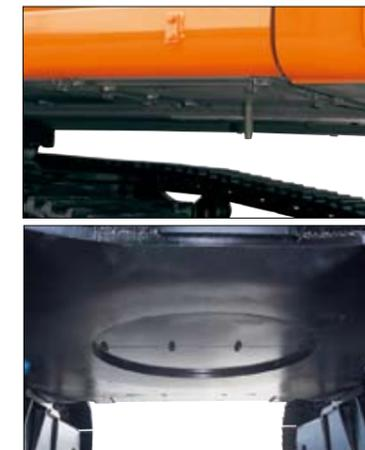
作業時に鉄筋などの突き上げから、ホース、配管、バルブなどを保護します。
