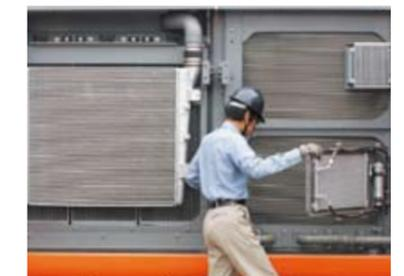
エアコンコンデンサを開閉式にすることで、エアコンコンデンサとその裏側に配置されたオイルクーラなどの清掃を簡素化しました。
