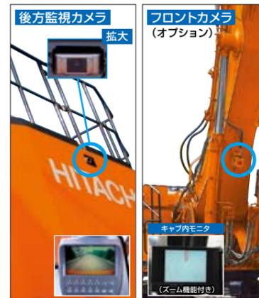
カウンタウイト部に後方監視カメラを搭載。キャブ内の液晶モニターで後方を確認でき旋回時および後進時の確認に役立ちます。また、破碎部分が確認できるチルトズーム機能付きフロントカメラをオプションで用意しました。
