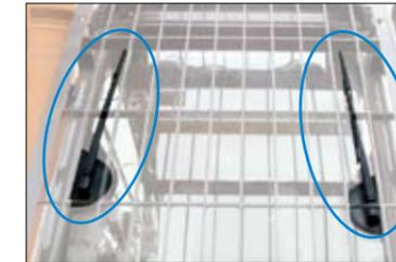
フロントガラスにツインワイパ、天窓に大型のワイパを採用。拭き取り面積が大幅に向上し、ほこりの多い解体現場で良好な視界を確保します。
