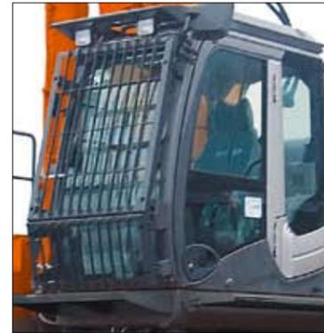
ISO規格のOPGレベルII（オペレータ保護ガード）に適合。落下物からオペレータを保護する安全性の高い構造です。さらに、見やすさにこだわりフラットバーガードを採用し、作業時の視界性を確保します。
