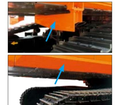
破碎したガラの巻込みを防止する巻込防止アングルおよびDフレームにアングル補強をオプションで用意しました。
