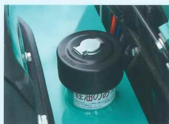
燃料タンク防じんキャップ LM MA SL HL 燃料給油口にはラバー被覆タイプでホコリが混入しにくいキャップを採用。
