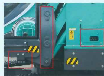
エレベータキャブ集中給脂 LM MA SL HL キャブ昇降機構部の給脂を地上の1カ所で行えるよう集中配置。
