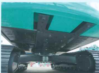
強化型上部本体アンダカバー LM MA SL HL 厚さ6 mmの強化型カバーを装備し内部機器を保護。
