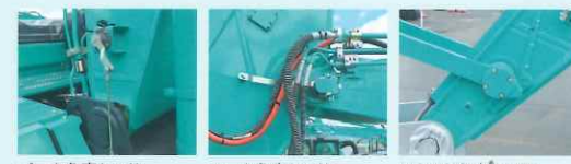
ブーム角度センサ アーム角度センサ バケット角度センサ
