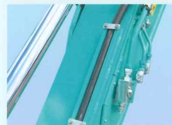
マグネットケーブルガード LM SL ケーブルの左右にガードレールを設け、引っ掛けによる断線を防止。
