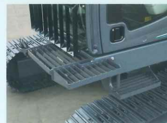
キャブ前方ステップ LM MA SL HL キャブ前面ガラスおよびガードの清掃がしやすい足場を設置。
