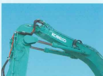
下付きアームシリンダ SL 力強いアーム持ち上げ力を発揮する下付き2本シリンダ。
