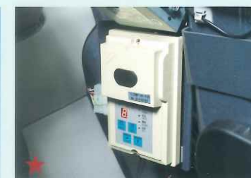
アタッチメント自動給脂装置 LM MA SL HL 決められた時間ごとに自動的に給脂。設定はキャブ内コントローラから。
