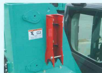
エレベータキャブメンテナンスストップ LM MA SL HL キャブ昇降機構の点検・整備時のキャブ自然降下に備え、作業員の安全を確保。
