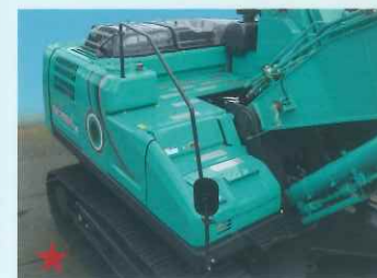
メンテナンススペース&ハンドレール LM MA SL HL エンジンボンネット内の点検などが安心して行えるアップ上部空間。
