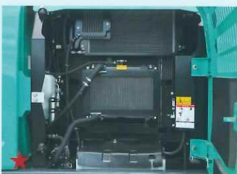
サブラジエータ LM MA SL 高出力パワーユニットの最適なヒートバランスを維持するために追加装備。
