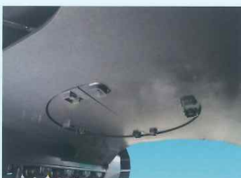
ロワアンダカバー LM MA SL HL ロワカーボディ下面に厚さ9 mmの強化型カバーを装備。
