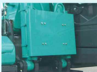
ブームフットガード LM MA SL HL スクラップの接触や飛散による配管やバルブ類の損傷を防ぐ大型ガードを装備。
