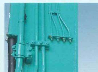
アタッチメント集中給脂 LM MA SL HL アタッチメント各ピン部の給脂箇所を集中配置して省力化。
