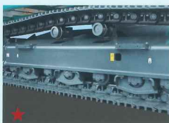
増設トラックガイド LM MA SL HL 脱輪を防ぐトラックガイドの追加装備が可能。
