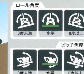
車体のロール角(左右)とピッチ角(前後)をモニタ画面の上端に表示します
