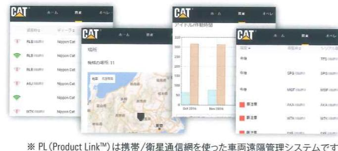
※ PL (Product Link™) は携帯/衛星通信網を使った車両遠隔管理システムです
