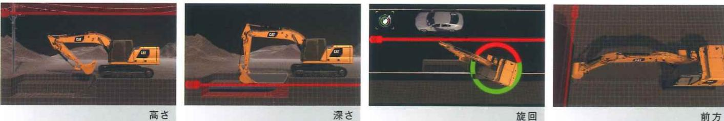
E-フェンスは、「高さ」「深さ」「前方」「キャブ(干渉防止)」「旋回」の作業範囲を制限し、制限範囲に近づくと自動静止します
