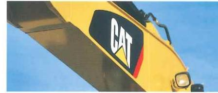
負荷のかかる箇所には高張力鋼を多用し、バッフルプレートで内部補強した大断面構造による軽量で高強度のフロント部です。
