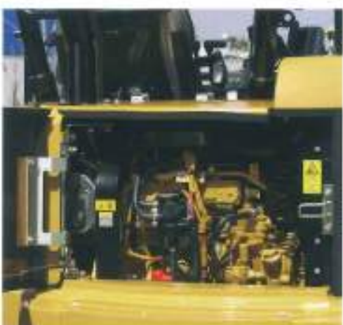
2) 点検箇所を集中させたエンジンサービスドア
