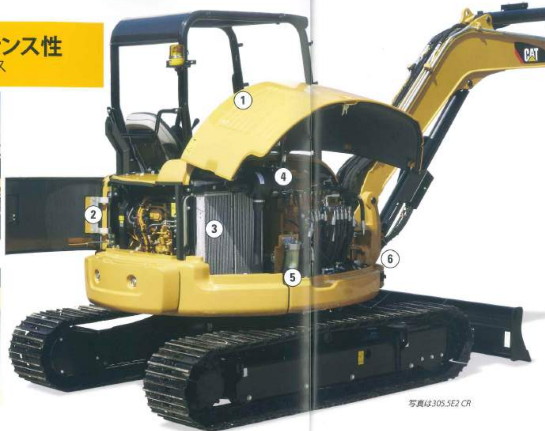
2) 点検箇所を集中させたエンジンサービスドア
